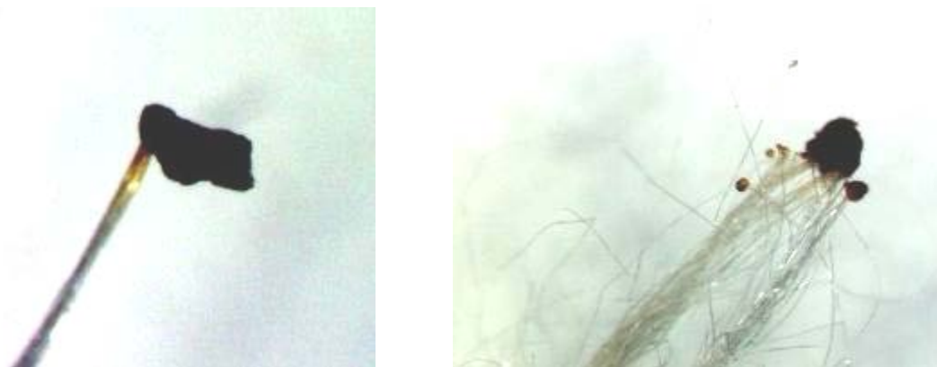
Фота 41. Рэакцыя на спаленне шаўковай ніці (а – кантрольны узор натуральнага шоўку, б – іспытуемае валакно)
