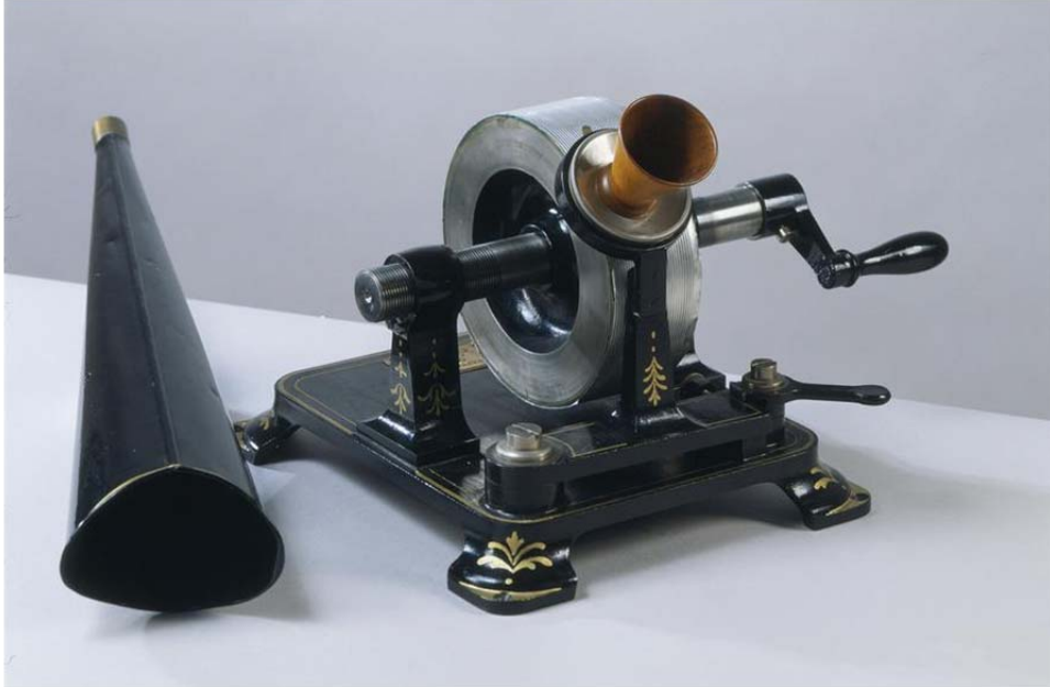
Рис. 1. Фонограф из оловянной фольги системы Эдисона, известный как демонстрационный фонограф. Музей искусств и ремесел, Париж [564]
