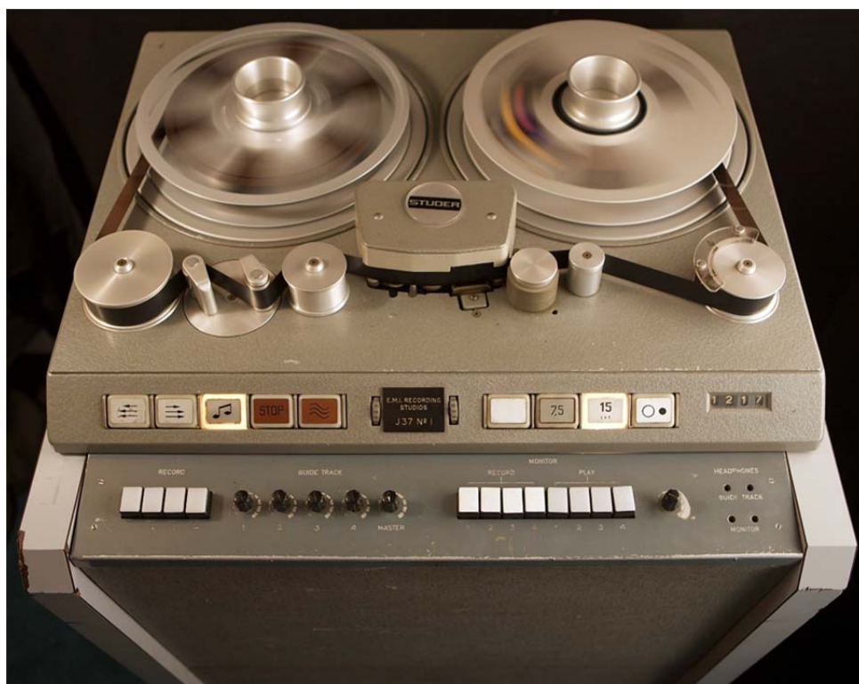
Рис. 17. Бабинный магнитофон с легендарной лентой Studer J37, используемой на Abbey Road с 1965 г. Благодаря его появлению получила развитие 4-дорожечная запись на магнитной ленте [528]
