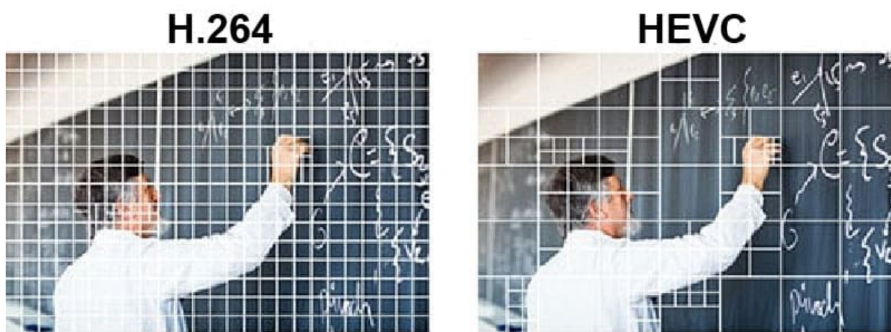
Рисунок 8 – Сравнение алгоритмов сжатия H.265 (HEVC) и H.264 (AVC)
