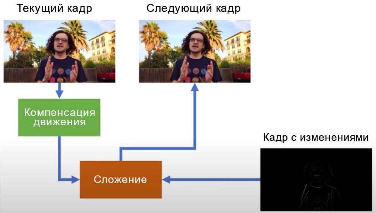
**Рисунок 7 – Как работает компенсация движения при воспроизведении (декодировании)**
