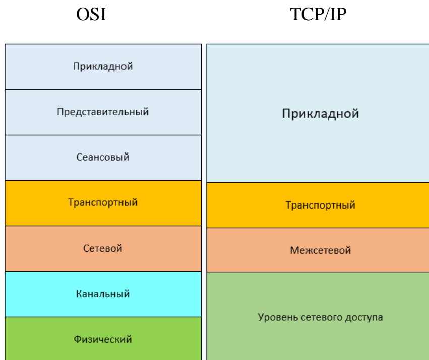
Рис. 9.4 – Модели OSI и TCP/IP
